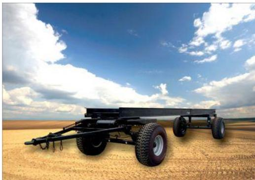
Шасси выпускается с размерами площадки: длина 8000 мм., ширина от 2400 до 3000 мм. По желанию заказчика допускаются другие типоразмеры. Грузоподъемность от 6,5 до 10,5 тонн. Агрегируется с колесными тракторами класса 20-30кН с мощностью двигателя 100-225 кВт (140-300 л.с.) типов МТЗ-142, МТЗ-100/102, ЛТЗ-155, Т155К, К-701.
