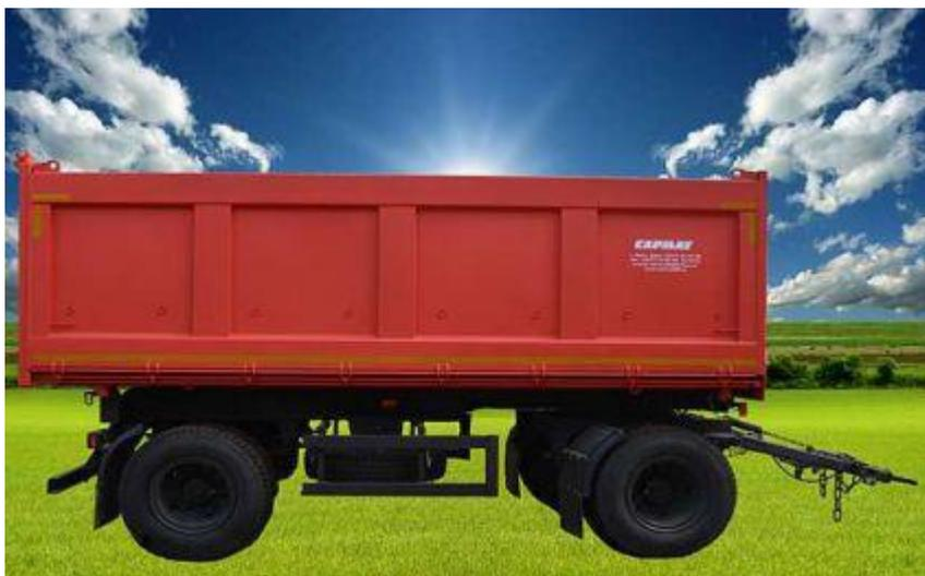
Предназначен для перевозки сыпучих, штучных сельскохозяйственных, строительных и прочих грузов как по дорогам с твёрдым покрытием, так и по грунтовым. Надёжность этого прицепа обусловлена применением в конструкции кузова, рамы и подвески специальных легированных конструкционных сталей. Оси собственного производства допускают значительные динамические нагрузки и перегрузки.
