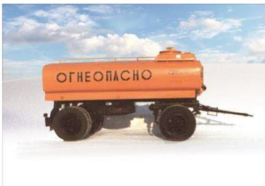
Предназначен для перевозки жидких нефтепродуктов плотностью до 0,86 г/см. куб. по всем видам дорог с твердым покрытием. Вместимость емкости 10,2 м. куб. Прицеп агрегируется с автомобилем с мощностью двигателя 150 кВт (210 л.с.) типа КАМАЗ.
