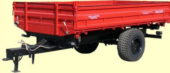
Полуприцеп тракторный одноосный Сармат 952610-0000010 предназначен для перевозки штучных и сыпучих грузов как по дорогам с твердым покрытием, так и с грунтовыми.
